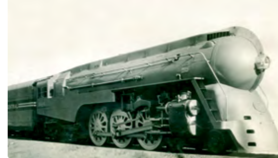
Stromlinien-Dampflokomotive Super-Hudson J-3a der New York Central Railroad, Entwurf: Henry Dreyfuss. In Frankreich, Deutschland und den USA wurden Anfang der 1930er Jahre Versuche im Windkanal unternommen. Technische Konstruktionsbüros der Hersteller entwickelten daraus strömungsgünstige Verkleidungen.
